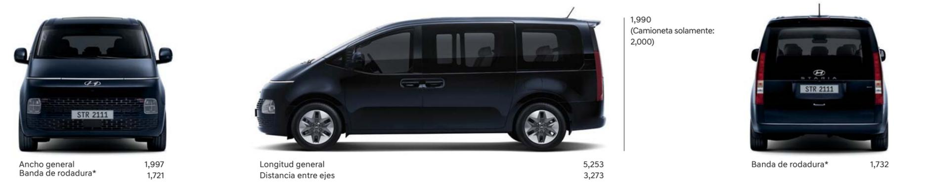
Unidad: mm \* Banda de rodadura • llantas de 18" (delantera/trasera): 1,721/1,732 • llantas de 17" (delantera/trasera) : 1,732/1,743 • llantas de 17" solamente para camioneta (delantera/trasera) : 1,732/1,716
